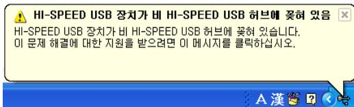
2. 핑키 햄스터(HFDU06)와 핑키 햄스터 II(HFDU06M/06S)는 USB2.0 에서 최적의 성능을 낼 수 있도록 제작되었습니다. USB1.1 허브에 연결되면 정상동작하지 못할 수 있으니 반드시 USB2.0 controller 에 연결하여야 합니다.
