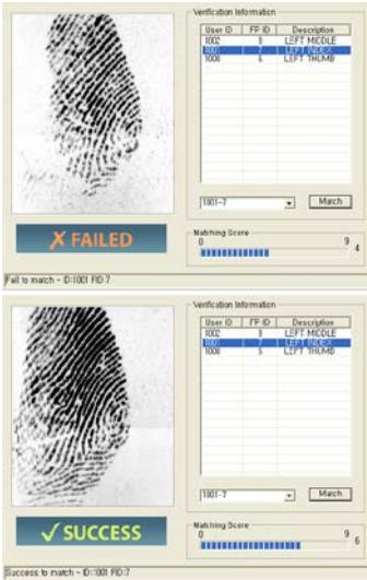
4. Matching Score는 인증을 시도할 경우 출력되는 값으로 입력 받은 지문과 기존에 존재하는 지문 데이터간에 매칭을 해서 얻은 값입니다. 매칭 점수는 0 ~ 9 범위를 가지며 이 점수와 General 탭에 있는 Security Level의 값을 비교해서 성공과 실패를 결정 합니다. Security Level이 5일 경우 매칭 점수가 이보다 낮으면 인증 실패가 되고 이상이면 성공이 됩니다. 인증 시도하는 지문의 상태가 건조하다거나 습할 때, 혹은 지문을 제대로 입력하지 않았을 경우 매칭 점수가 낮게 나올 수 있습니다.
