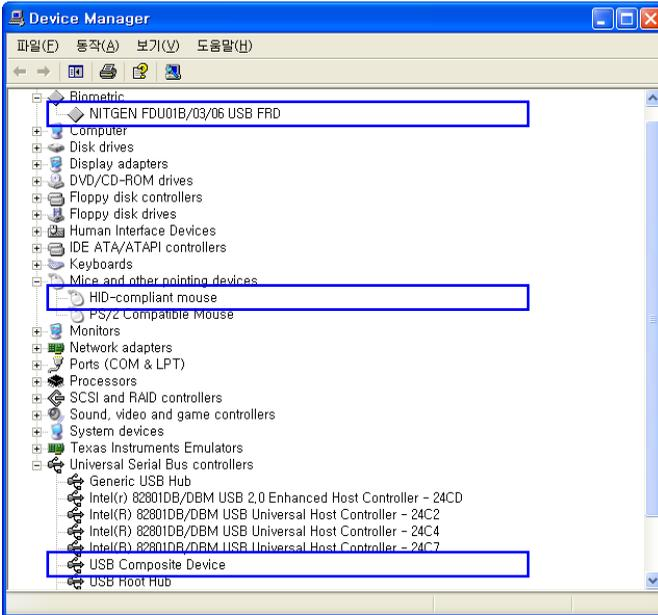
3. 만약, USB 키보드에 있는 USB 포트나 Hub 에 지문인식 핑키 마우스를 연결하여 사용하고자 한다면 USB 키보드나 Hub 가 자체 공급 전원을 가지고 있는지 확인해보십시오. USB 지문인식 핑키 마우스의 소비전력은 110mA 정도이므로 자체 공급전원이 없는 Hub 나 키보드에는 연결하여 사용할 수 없습니다.
