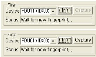
2. 디바이스를 선택하고 “Init” 버튼을 클릭합니다. 하나의 디바이스를 양쪽에서 동시에 사용할 수 없습니다. 지원 가능한 디바이스는 HFDU04/06, HFDU11/14/06M/06S, MFDU03/13, MFDU06 입니다. HFDU06 과 HFDU11/14/06M/06S는 AutoOn 기능을 이용하고 HFDU04와 MFDU03/13, MFDU06은 “Capture” 버튼을 클릭해야 합니다.
